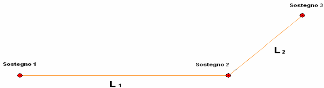
Figura 6 – Configurazione di una tratta con due campate non rettilinee tra loro (angolo di 135°).
